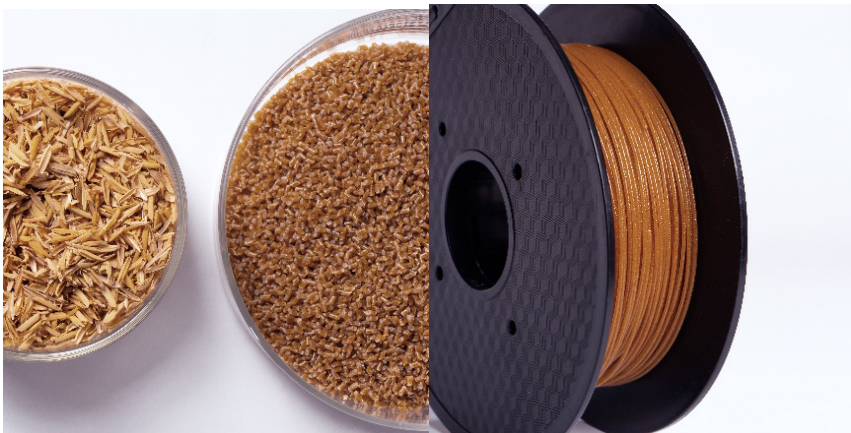
Figura 5. Título Biomasa residual (Izquierda) y bobina de filamento para impresión 3D a partir de PLA y cascarilla de cacao (Derecha)
