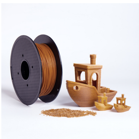
Figura 7. Título Filamento de cascarilla de arroz-PLA en carrete y prototipos impresos en 3D que ilustran la procesabilidad del material.
