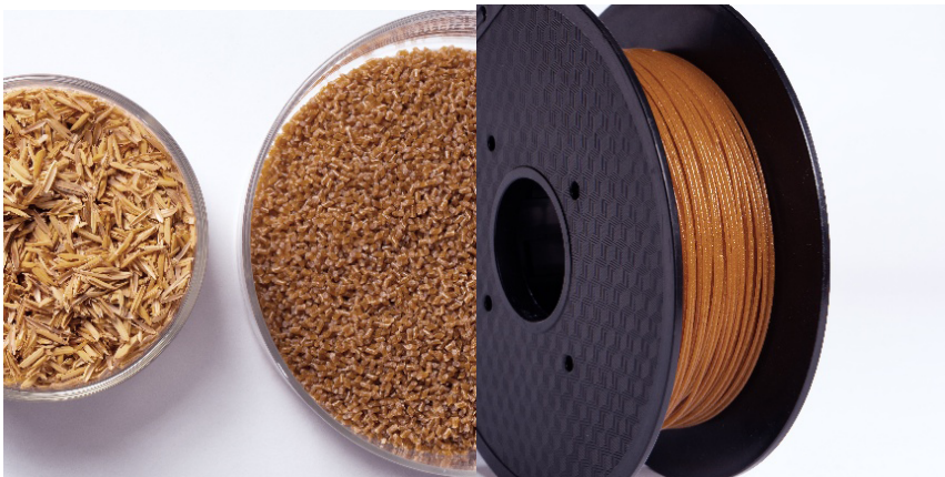
Figura 5. Biomasa residual (Izquierda) y bobina de filamento para impresión 3D a partir de PLA y cascarilla de cacao (Derecha)
