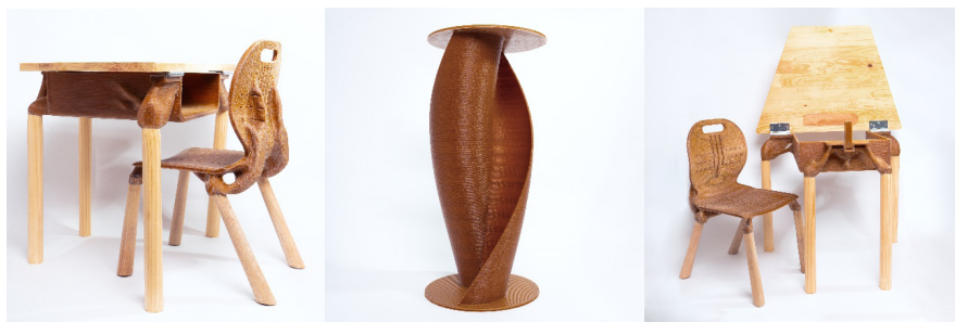
Figura 6. Título Mobiliario y turbina impresos en 3D a gran formato con un filamento de cascarilla de arroz y PLA
