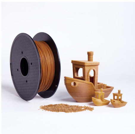
Figura 7. Filamento de cascarilla de arroz-PLA en carrete y prototipos impresos en 3D que ilustran la procesabilidad del material
