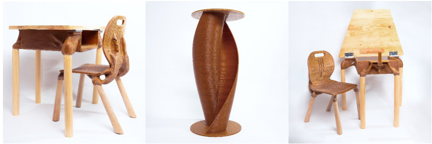
Figura 6. Mobiliario y turbina impresos en 3D a gran formato con un filamento de cascarilla de arroz y PLA
