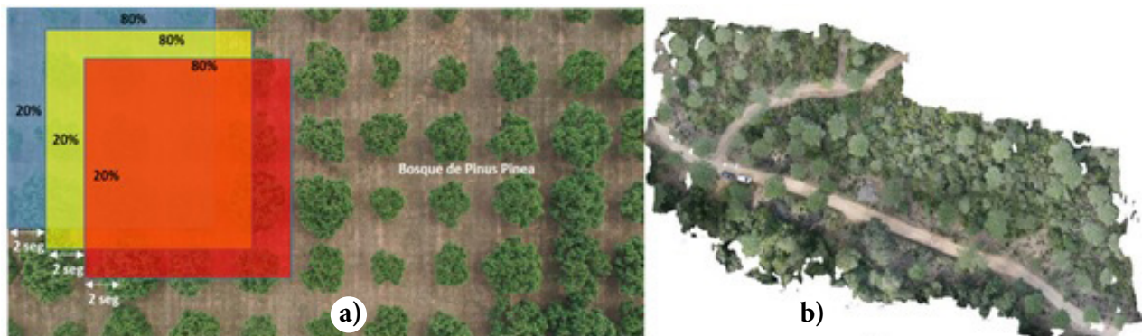
Figura 2. a) creación de ortomosaicos a partir de imágenes tomadas por VANT b) ejemplo de ortomosaico bosque nativo
